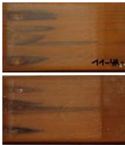
1 Streifig verfärbte Oberfläche infolge Beschädigung bei Plato-Fichte (oben) und Mirako-Buche nach 2200 h QUV
