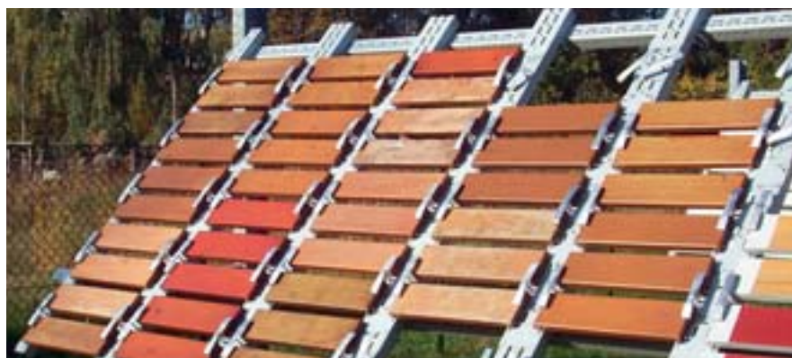
Oberfläche im Fokus: Thermoholzproben in der Freibewitterung am IHD in Dresden
