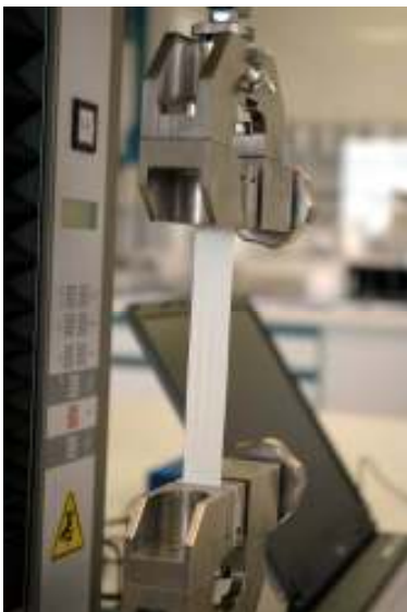
Bild: Zowo-plast® lässt sich auf mehr als das Doppelte seiner Länge ziehen, ohne dass der Lackfilm reißt; hier: Zugversuch in Anlehnung an DIN 53504
